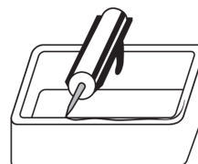
Durchgehende Silikonraupe auf dem Beckenrand.
