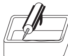
Cordón continuo sobre el canto del fregadero.
